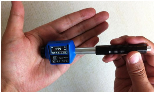
Principio de medición de la dureza Leeb
